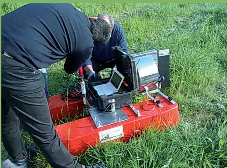
*Rilevamento del fondale dei canali di bonifica con il natante drone dotato di sonar e GPS, sviluppato dal Consorzio di Bonifica in collaborazione con la ditta SI2G di Ancona*
